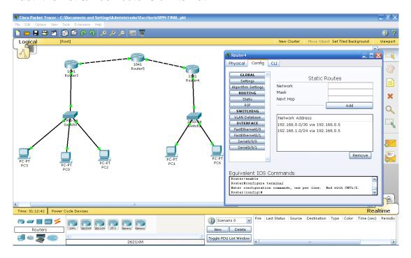
Para la conexión en la parte LAN se encuentra un switch y dos equipos, se configura la interface FastEthernet 0/0 la cual lleva la ip address 192.168.2.1 con una mascara de red 24: 255.255.255.0 :
