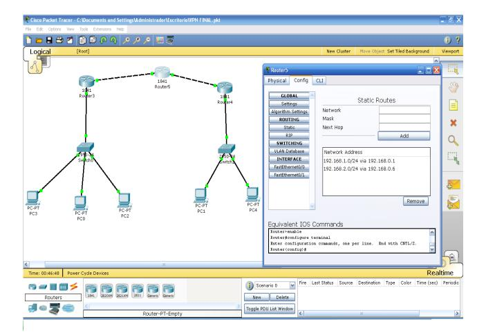
Se configura la interface FastEthernet 0/0 con la ip libre 192.168.0.2 mascara de red 30 que es la próxima de la WAN (FastEthernet 0/1) del Router 3:
