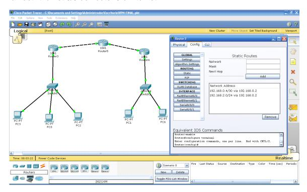
Ahora para la conexión en la parte LAN se encuentra un switch y tres equipos, se configura la interface FastEthernet 0/0 la cual lleva la ip address 192.168.1.1 con una mascara de red 24: 255.255.255.0 :
